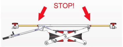
Внимание. Выход элементов регулировки ширины подставок под пороги, должен быть ограничен метками.
